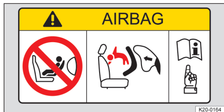
εικ. 1 Αυτοκόλλητο αερόσακου στο σκάδινο (γενική εικόνα).
