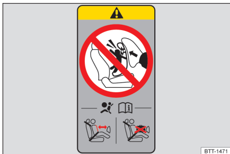
εικ. 2 Αυτοκόλλητο αερόσακου στην κολώνα Α ή στην κολώνα Β (γενική εικόνα).
